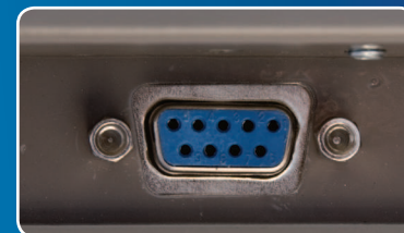
Port RS 232 do komunikacji z kasą fiskalną, komputerem i drukarką
